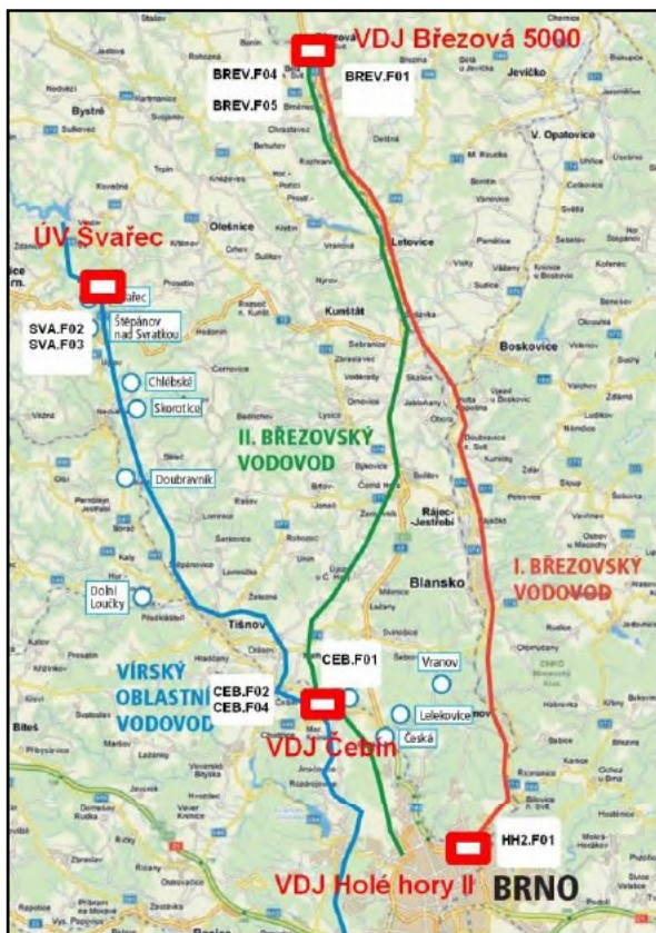
Obr. 1 Přivaděče Brněnské vodárenské soustavy – schéma včetně označení průtokoměrů
